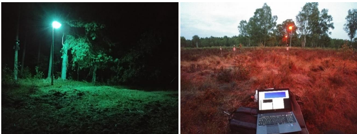
Figure 1. Illustrations d'exemples de sites expérimentaux aux Pays-Bas, à gauche un lampadaire vert et à droite un lampadaire rouge avec le matériel de suivi déployé.
