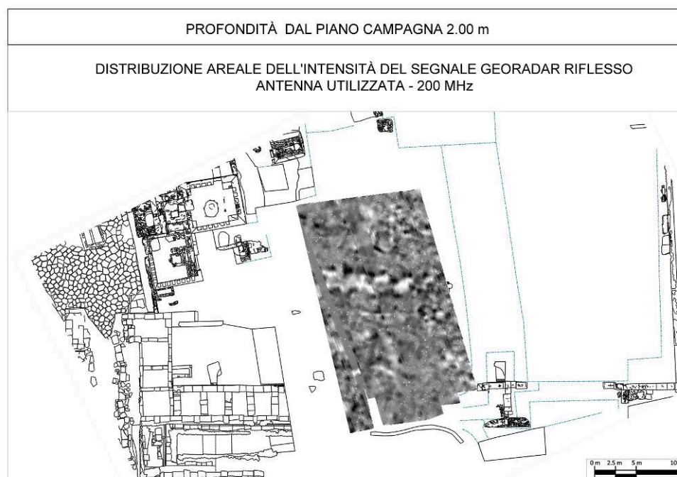
Fig. 18. Mappa georadar ottenuta con l'antenna da 200 MHz relativa alla profondità di 2 m dal piano campagna.
