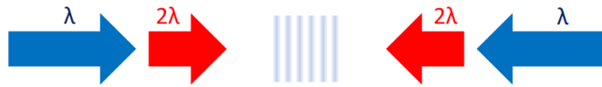
FIGURE III.6. Principe de la réalisation d'un super-réseau, avec la superposition de deux ondes lumineuses stationnaires, l'une à la longueur d'onde \lambda et l'autre à la longueur d'onde 2\lambda .
