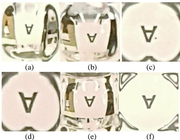
Fig. 7 Magnified views of the images of the letter 'A' formed by the fabricated lens arrays: (a) Lens1 (b) Lens2 (c) Lens3 (d) Lens4 (e) Lens5 (f) Lens6
