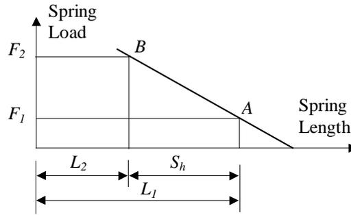
Fig. 2 Operating parameters
