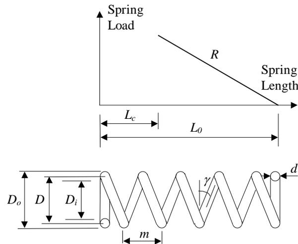
Fig. 1 Design parameters
