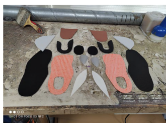
Photo 1 - Eléments de traitement de deux semelles orthopédiques avant encollage
