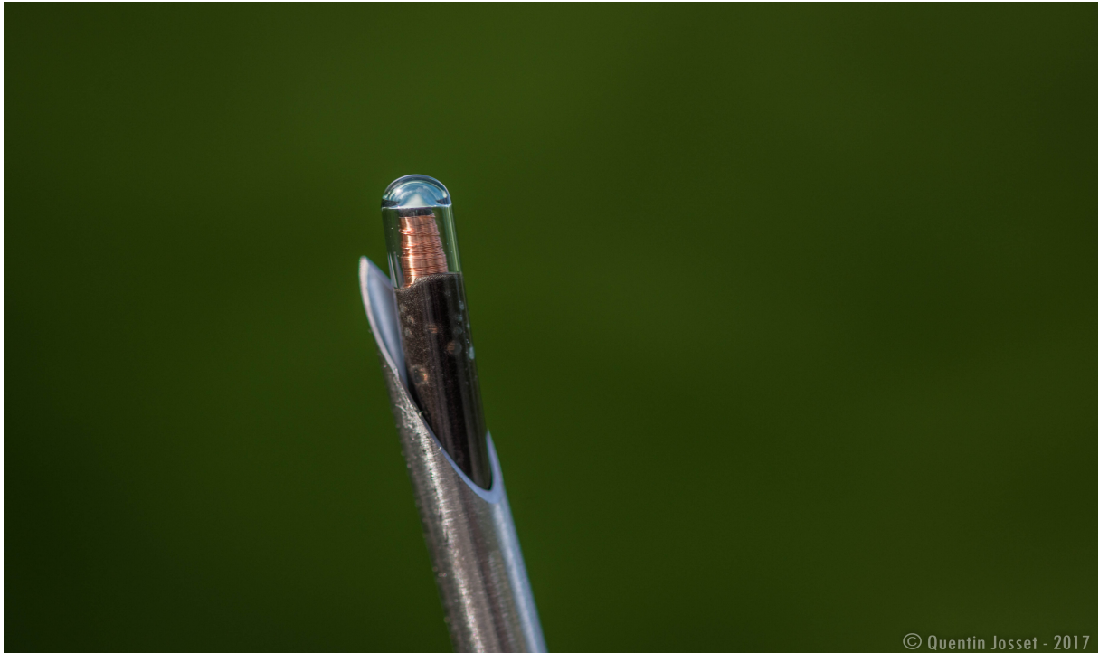
Figure V.1. Marque individuelle passive de type PIT-tag (12mm).
