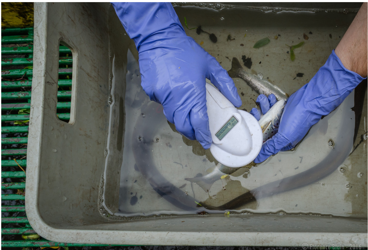
Figure V.4. Lecture d'une marque PIT-tag sur un individu recapturé
