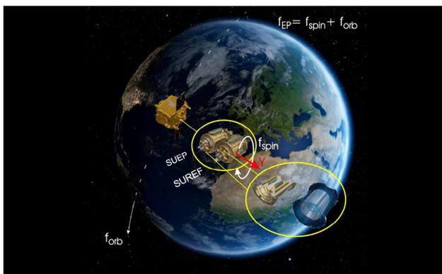
Visuel du satellite MICROSCOPE en orbite autour de la Terre avec un schéma des deux paires d'accéléromètres SUEP et SUREF. (crédit CNES / Virtual\_IT2017)
