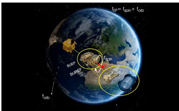
Visuel du satellite MICROSCOPE en orbite autour de la Terre avec un schéma des deux paires d'accéléromètres SUEP et SUREF. (crédit CNES / Virtual_IT2017)
