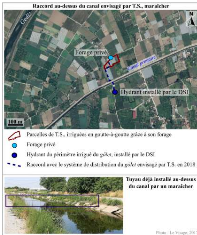
Figure 5 : Raccords passant au-dessus du canal primaire
