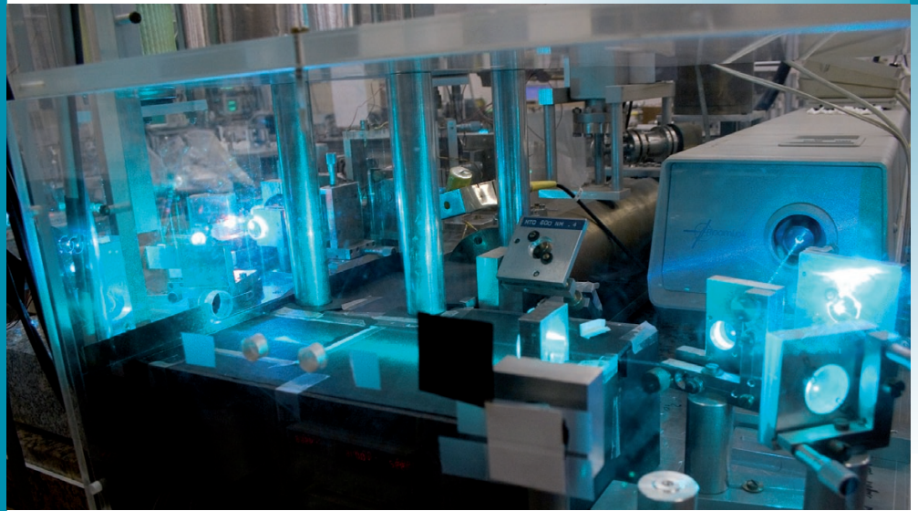
Système optique pour le pompage d'un laser titane-saphir, utilisé au LKB pour la détermination de la constante de structure fine, en mesurant la vitesse de recul d'atomes ultra-froids. © Jean-François DARS
