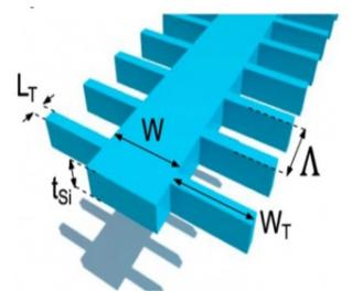
Exemple de cavité optomécanique présentant une forte dispersion et un faible amortissement acoustiques (membrane de silicium nanostructurée, C2N, Zhang et al.) [8]
