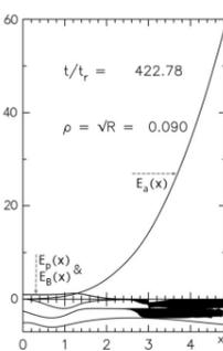
À gauche : miroir Brillouin inversé pour une forte dispersion et un fort amortissement acoustiques ( $\alpha = 1$ ,  $\mu = 21$ ). Noter les phases pompe et Brillouin turbulentes à l'extrémité de la fibre, quand la phase acoustique reste essentiellement constante. À droite : idem, pour un amortissement acoustique modéré ( $\mu = 7$ ) Noter la croissance extrêmement rapide de l'amplitude acoustique
