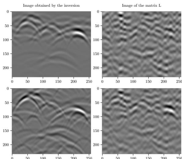
FIG. 2: Résultats de l'inversion robuste avec l'image reconstruite (en haut à gauche) et la matrice  $L$  (en haut à droite). Même chose pour l'inversion classique sur le bas de l'image. Le paramètre de sparsité est fixé à  $\lambda = 0.4$  et le nombre d'itérations de l'ADMM est de 500.
