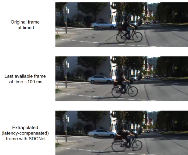
FIGURE 3 – Résultats qualitatifs pour une compensation de latence de 100 ms. Le schéma d’extrapolation côté décodeur est utilisé. Le codec HEVC utilise un paramètre de quantification QP = 32 . Images tirées de la base de données Kitti.
