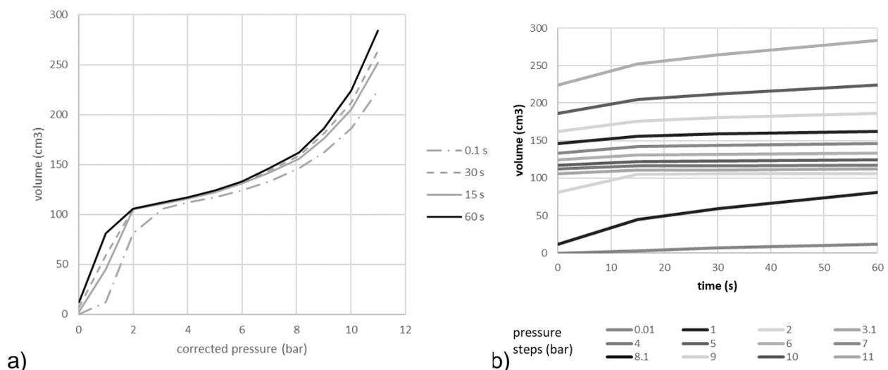
Figure 2. Évolution des courbes pression-volume en fonction du temps (sable, profondeur 1m, Decize, France)
