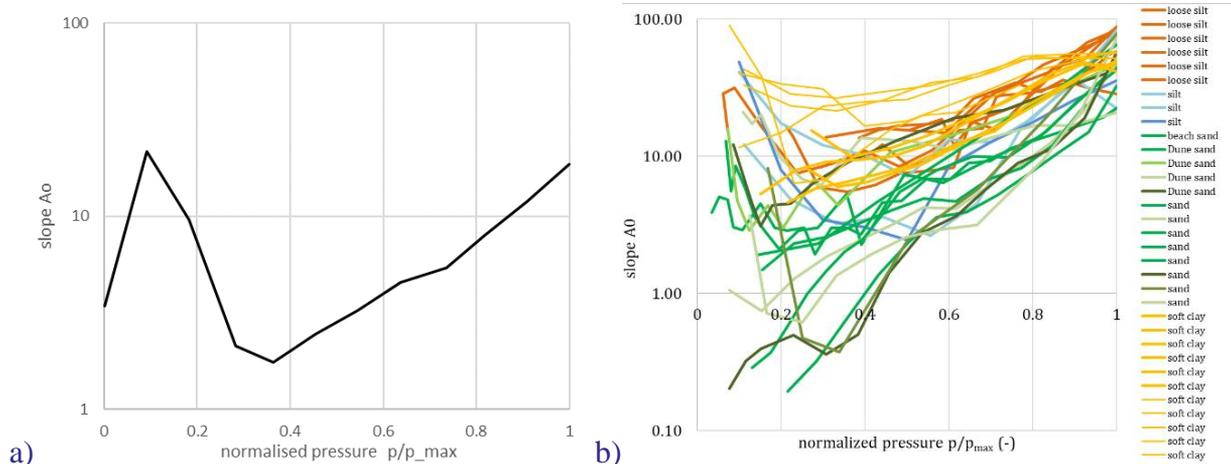
Figure 3. Évolution du paramètre  $A_0$  lors d'un essai (sable, profondeur 1m, Decize, France) et pour 13 sites différents
