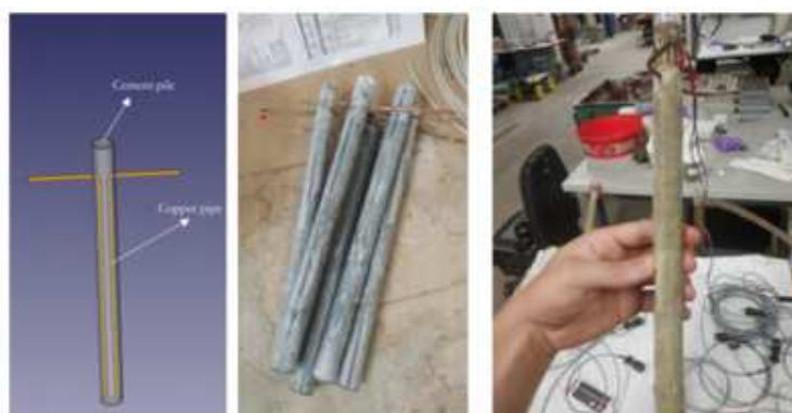
Figure 2. Schéma d'un pieu géothermique modèle, photographie de pieux avant et après sablage
