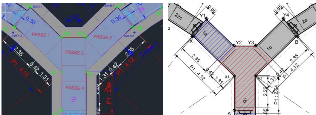
Figure 8. Panneautage (gauche) et cages d'armatures au droit du Y (droite)
