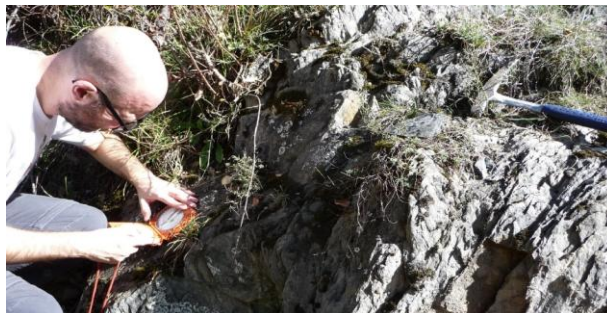
Figure 5 : Levé de discontinuités sur affleurement rocheux dans les terrains marneux albien n5a.
