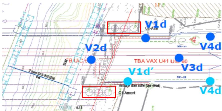
Figure 2. A gauche : implantation des capteurs de vibration sur la culée C1 (rive droite) côté aval (V1d à V4d). Les 2 capteurs excentrés par rapport aux voies (V1d et V4d) sont déplacés en positions V1d' et V4d' lorsque le chantier passe dans le quadrant C1-amont. Les pieux définitifs faisant l'objet des travaux sont encadrés en rouge). A droite : implantation du capteur V4 sur le plot de fondation d'un poteau caténaire.
