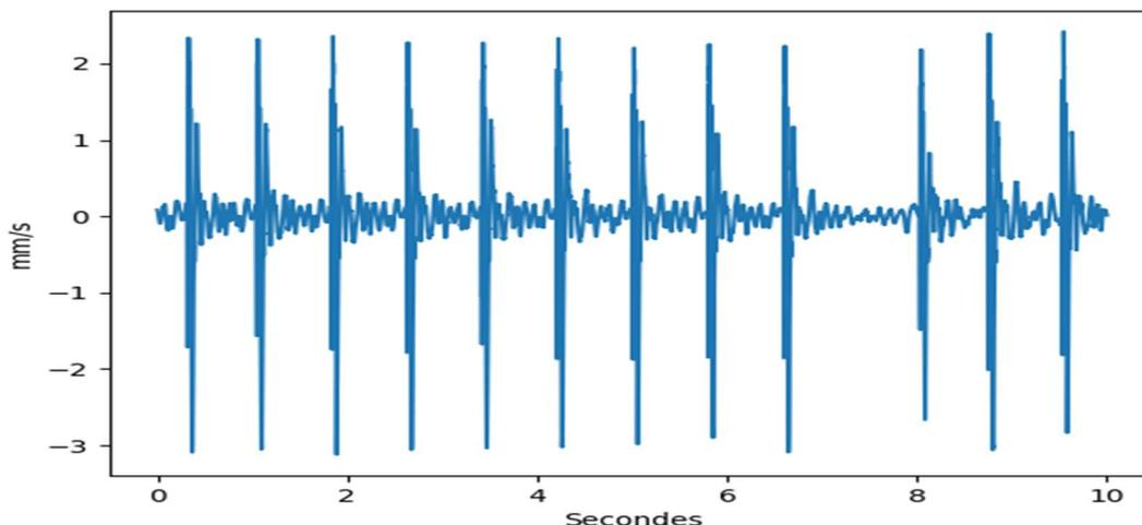
Figure 3. Série temporelle typique ayant pour origine le battage des tubes métalliques.
