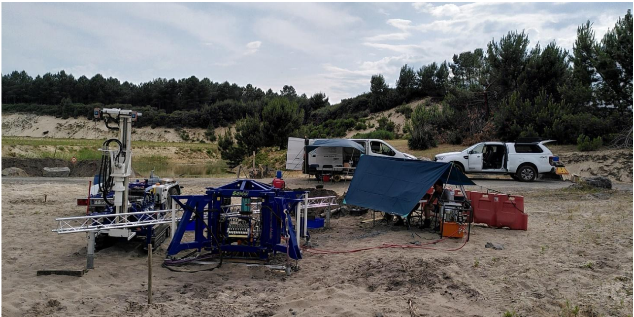
Figure 5. Vue générale du bâti avec la camionnette contenant le groupe et la centrale de mesure
