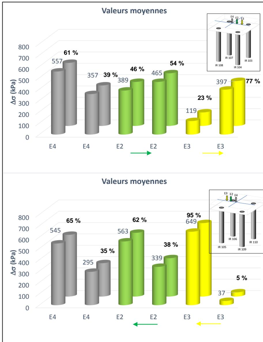
Figure 6. Augmentations de contrainte mesurées sur les inclusions rigides des plots 1, et 3 en fin des essais E4, E2 et E3
