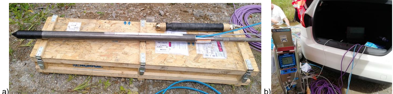
a) b) Figure 2 (a) Matériel pressiométrique (sonde nue et tube fendu) et (b) Poste de travail de l'essai pressiométrique mis en œuvre sur le chantier
