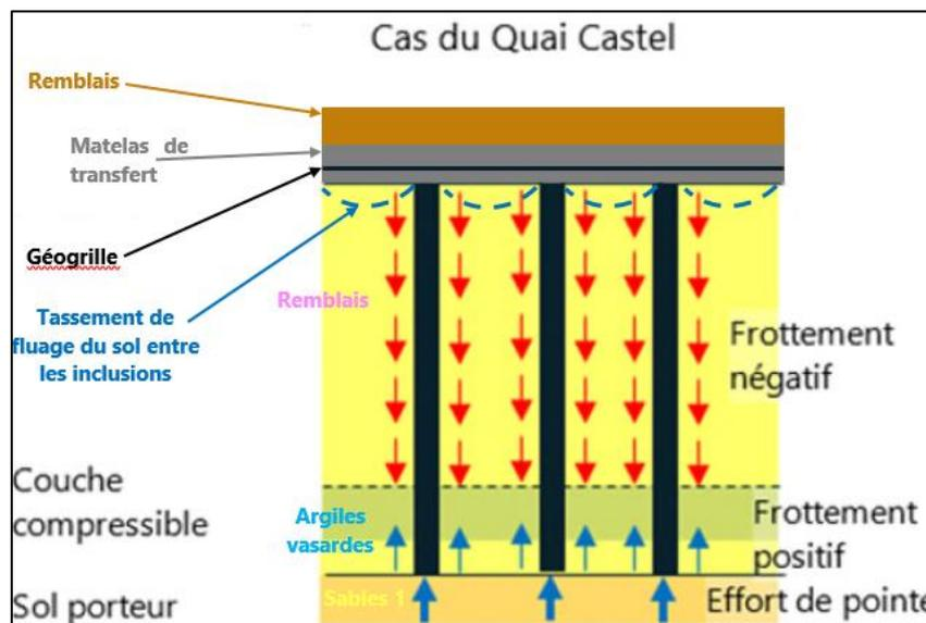
Figure 6. Principe de fonctionnement des inclusions rigides
