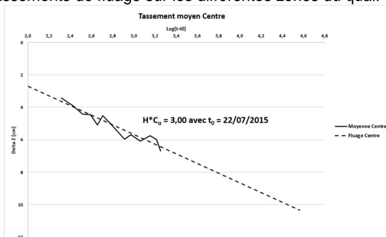
Figure 5 : Exemple de suivi topographique avec estimation du  $H^* C_\alpha$
