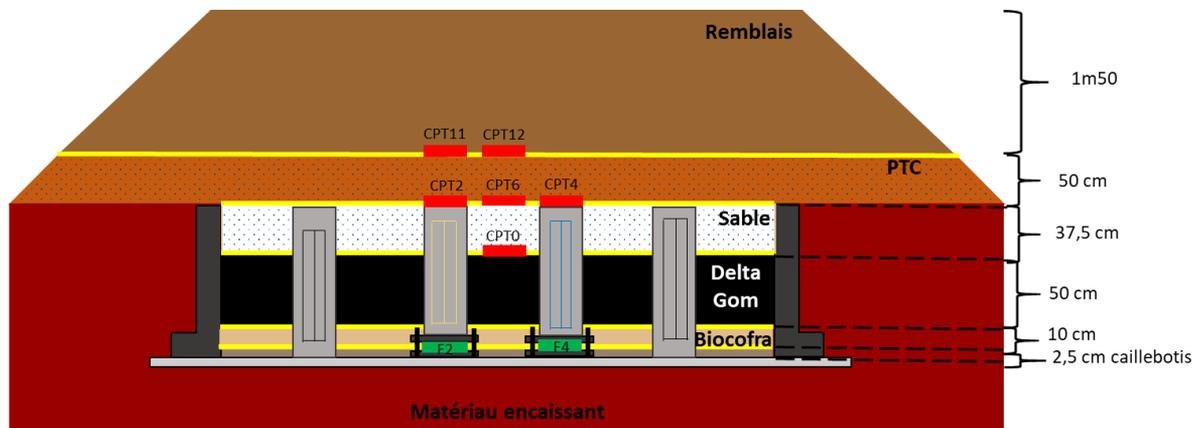
Figure 3. Positions des CPT et des anneaux de force
