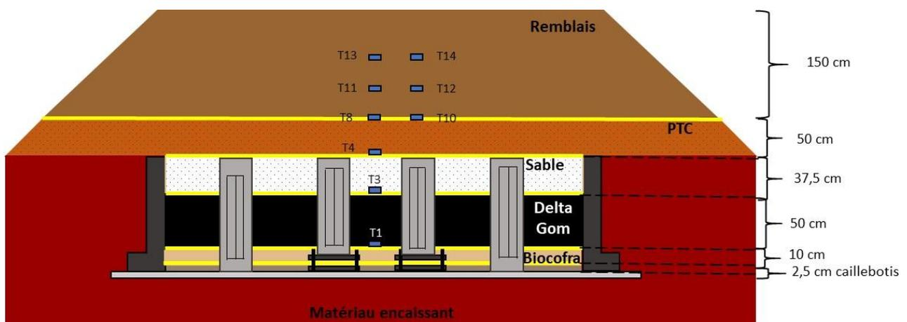
Figure 4. Positions des capteurs de tassement
