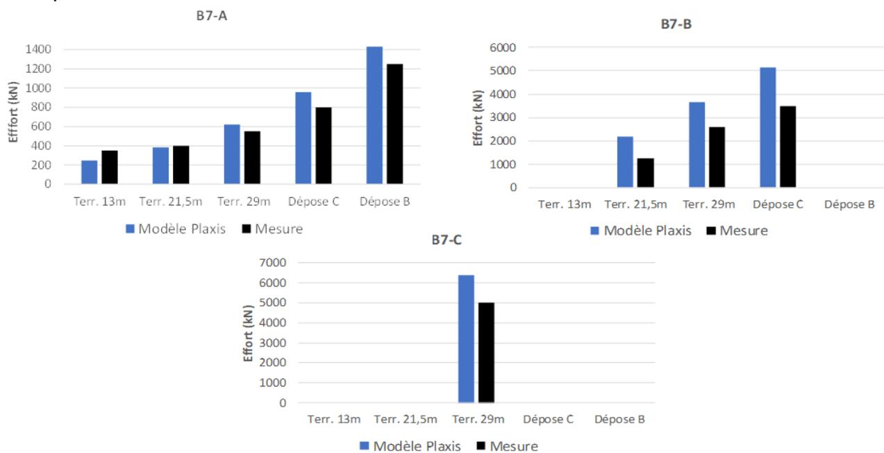
Figure 9 : Comparaison entre les efforts mesurés et calculés
