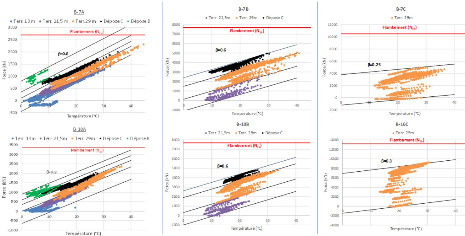
Figure 6 : Variation de l'effort avec la température pour les butons 7 et 10 des 3 lits instrumentés A, B et C (16C est présenté à la place de 10C car les jauges de ce dernier ont été endommagées)
