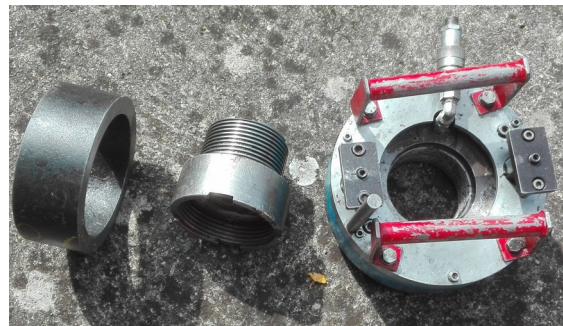
Figure 2. Exemple de plaque d'appui, chaise et vérin utilisés
