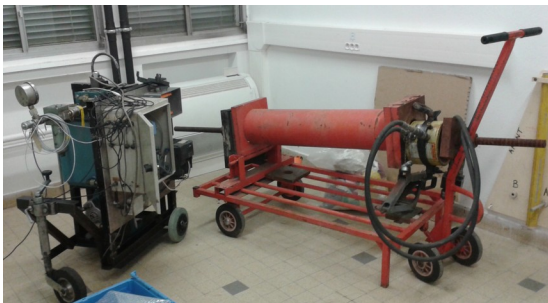
Figure 1. Groupe hydraulique (à gauche) et banc d'étalonnage (à droite)
