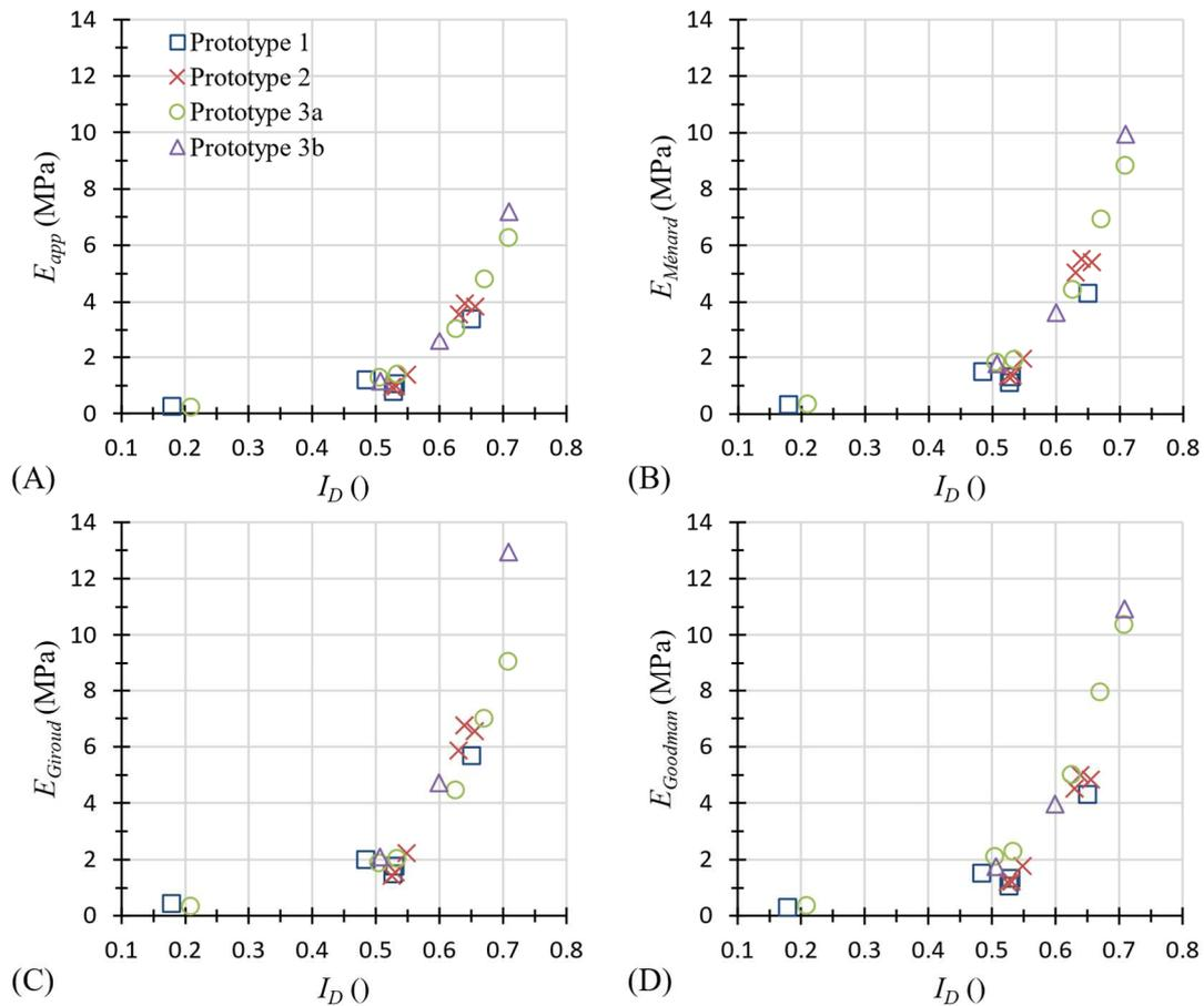
Figure 7. Modules du sable HN31 obtenus avec les différents prototypes Dilatosol.
