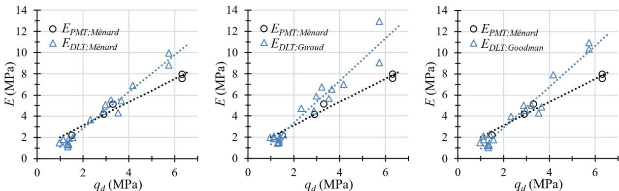
Figure 8. Comparaison des modules Dilatosol (DLT) avec les modules pressiométriques (PMT).
