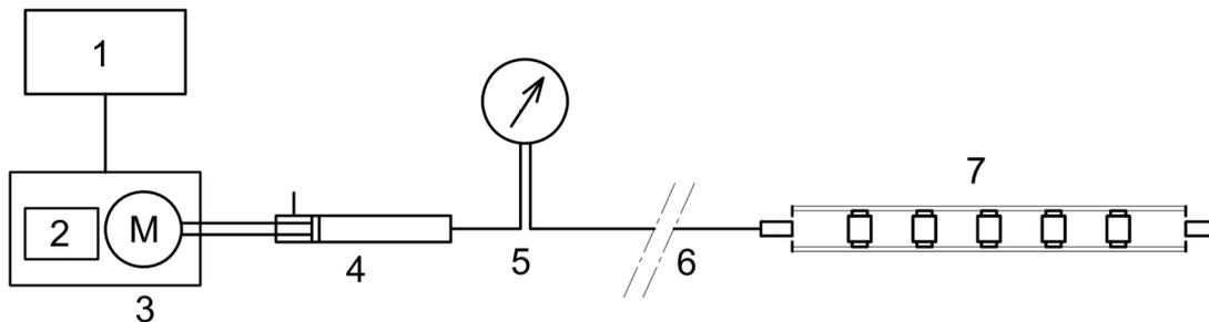
1 ordinateur                      3 moteur électrique                      5 capteur de pression                      7 demi-coquille
