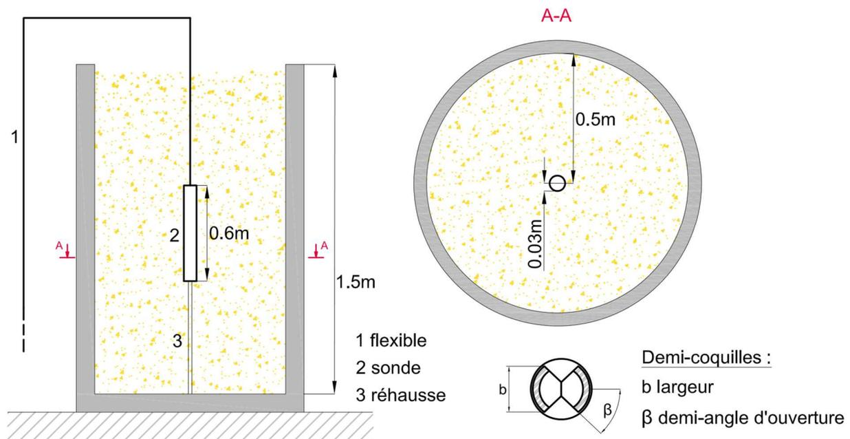
Figure 4. Le Dilatosol dans la chambre d'étalonnage.
