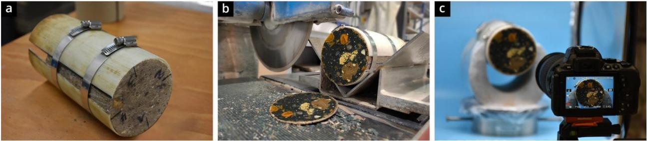
Figure 3. a) Système de maintien des éprouvettes qui ont subi l'essai de résistance à la compression simple ( $R_c$ ) avant le sciage ; b) Sciage des éprouvettes en tranches à l'aide d'une scie à matériaux et c) Acquisition d'images à l'aide d'un appareil photo numérique.
