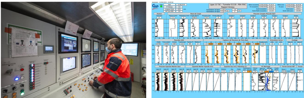
Figure 3 - Cabine de pilotage du tunnelier (à gauche) et un exemple d'image de rapport informant sur les paramètres de pilotage du tunnelier (à droite)
