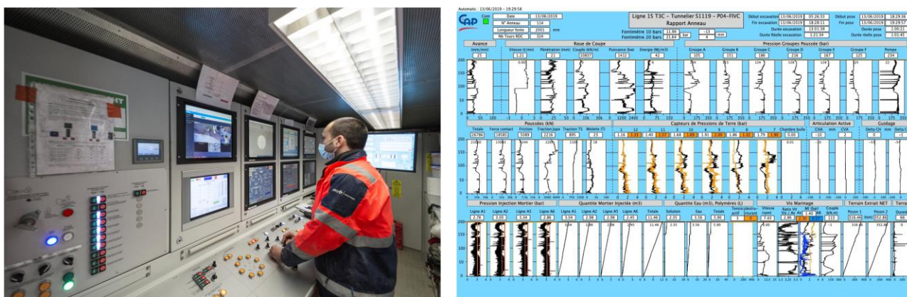
Figure 3 - Cabine de pilotage du tunnelier (à gauche) et un exemple d'image de rapport informant sur les paramètres de pilotage du tunnelier (à droite)
