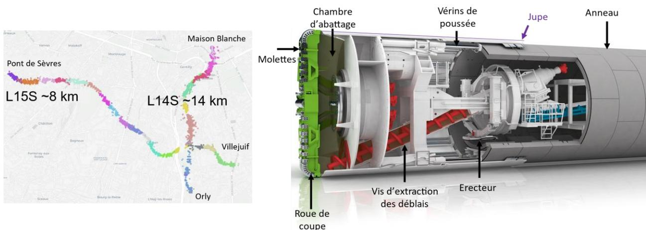
Figure 1 - Tracés des lignes L14SGC02 et L15SO (à gauche) et vue écorchée d'un tunnelier à pression de terre (à droite)
