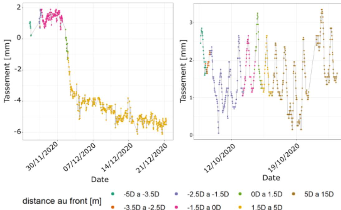
Figure 7 - Illustration de la qualité des données collectées par deux capteurs différents le long du tracé de la L15SO.
