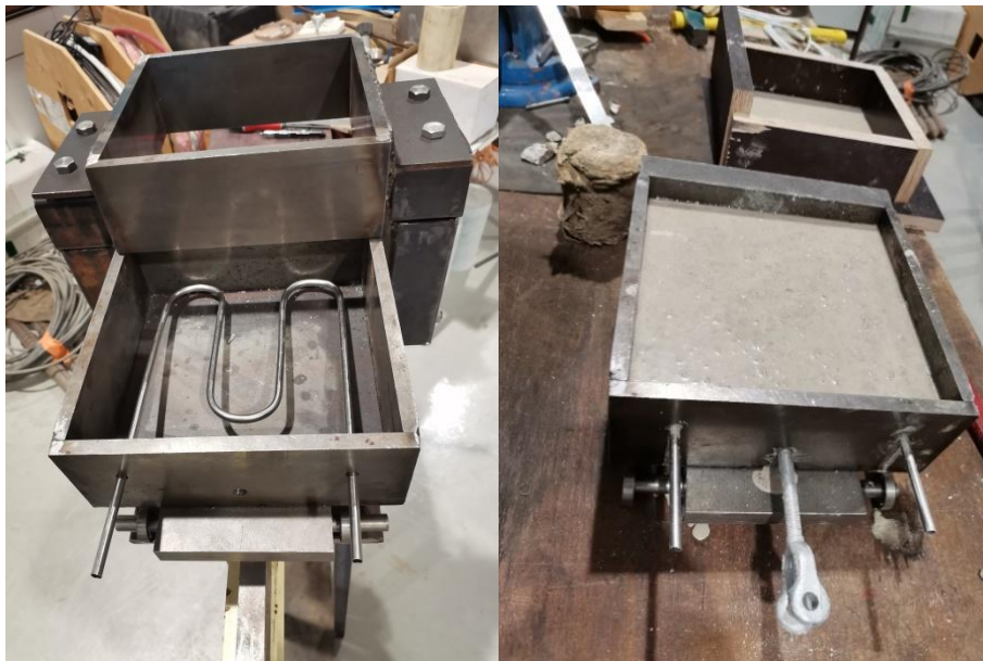
Figure 1 : Photos de la boîte de cisaillement en cours d'assemblage.
