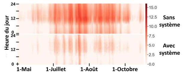
Figure 8 : Surchauffe intérieure  $WBGT - 20,09^\circ\text{C}$
