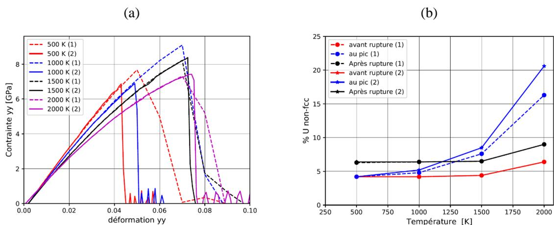
Figure 4 - Courbes contrainte-déformation obtenues pour plusieurs températures et deux vitesses de déformation : (1)  $10^9$  s<sup>-1</sup> et (2)  $10^8$  s<sup>-1</sup>, pour le joint de grains [110], (111)  $\Sigma 3$  (a) – Proportions des atomes d'uranium non-fcc en fonction de la température obtenue avec l'analyse CNA (Common Neighbor Analysis) (b)
