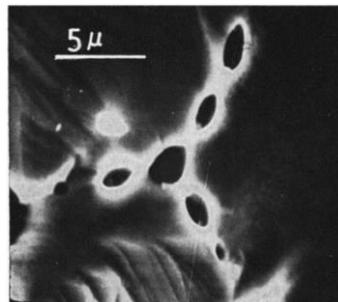
Figure 1 – UO<sub>2</sub> irradié présentant des bulles intergranulaires [1].
