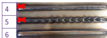
Figure 2 – Différents types de pièces fabriquées en acier inoxydable 316L avec le procédé TIG-WAAM.
