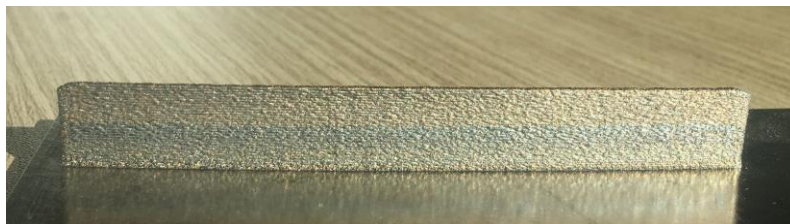
Figure 7 – Photo d'un mur en inox 316L-Si fabriqué par DED – LP
