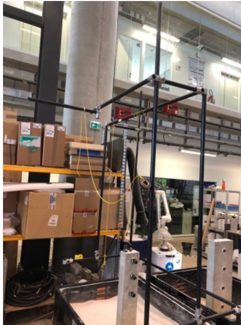
FIGURE 2 – Dispositif d'excitation : portique, corde et masse en guise de pendule pour l'impact.
