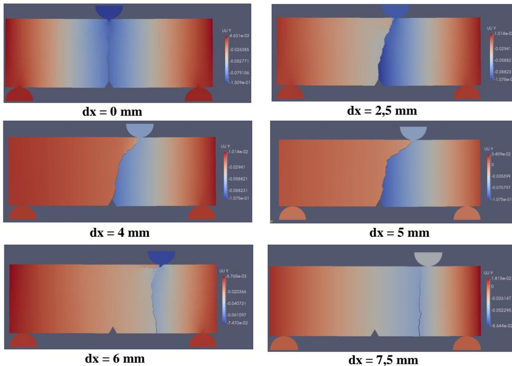
**Figure 7 – Champs de déplacement des éprouvettes de pâte de ciment en flexion 3 points avec une excentré de charge de  $dx$ .**
