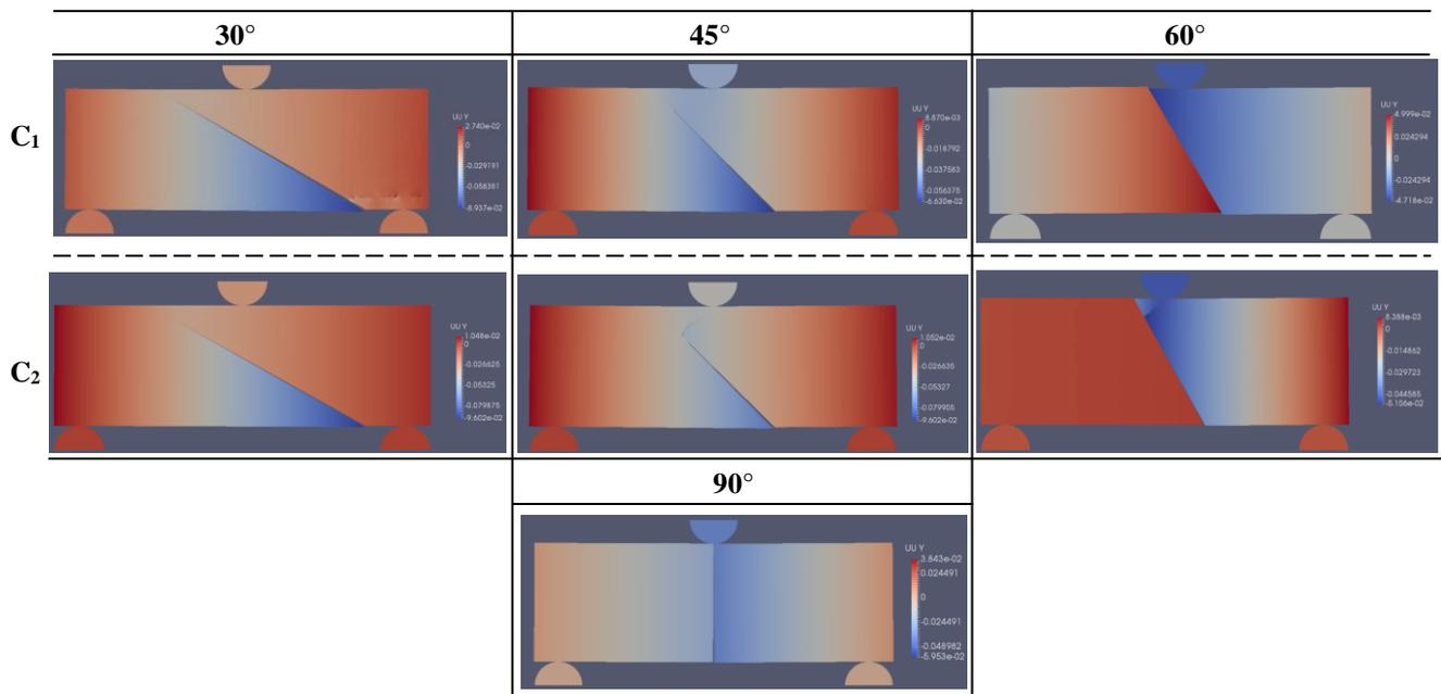
Figure 9 – Champs de déplacement des éprouvettes composites avec granulat incliné (30°, 45° et 60°) et granulat droit en deux configurations (C1 et C2) en flexion 3 points avec chargement symétrique.
