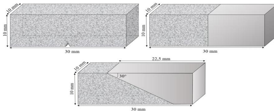
**Figure 1 – Géométrie des éprouvettes : pâte de ciment s(en haut à gauche); composite à granulat droit d'angle d'interface  $90^\circ$  (en haut à droite); composite à granulat incliné d'angle  $30^\circ$ .**
