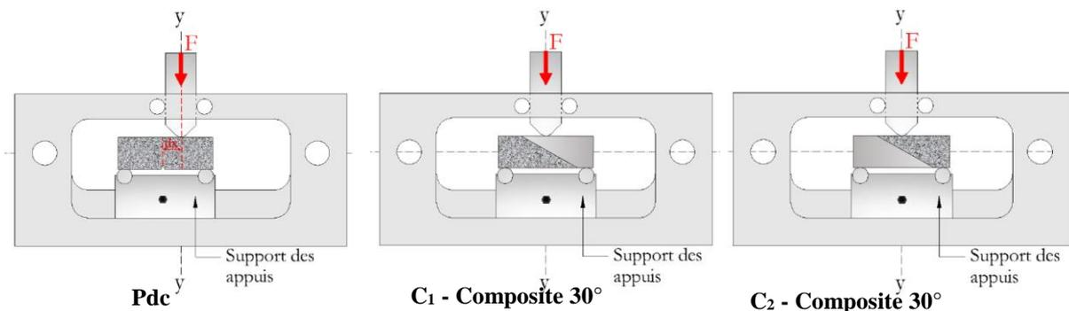
**Figure 3 – Conception du banc de flexion 3 points modulable.**
