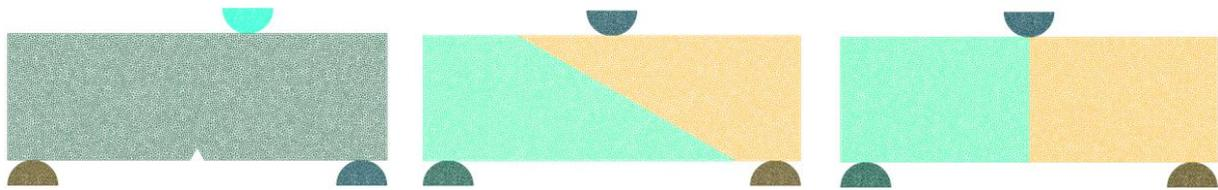
**Figure 6 – A gauche : maillage de la pâte de ciment pour l’essai de flexion 3 points excentré. Au milieu : maillage de composite avec granulat incliné de 30°. A droite : maillage de composite avec granulat droit (90°).**
