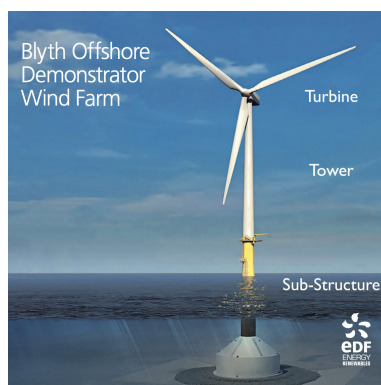
FIGURE 1 – Composants d'une éolienne offshore
