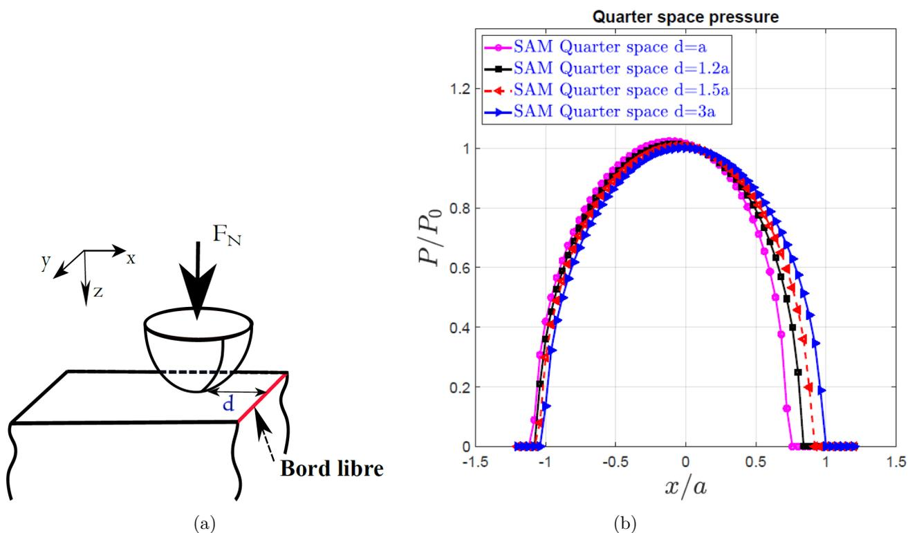
FIGURE 8 – a) Quart de massif avec le bord situé à une distance  $d$  du centre de contact b) Champ de pression solution en fonction de la distance  $d$
