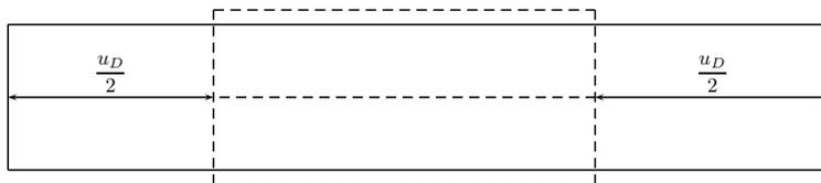
FIGURE 4 – Poutre en traction, déplacement imposé
