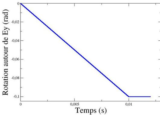
FIGURE 8 – Rotation imposée (rad) en flexion pure
