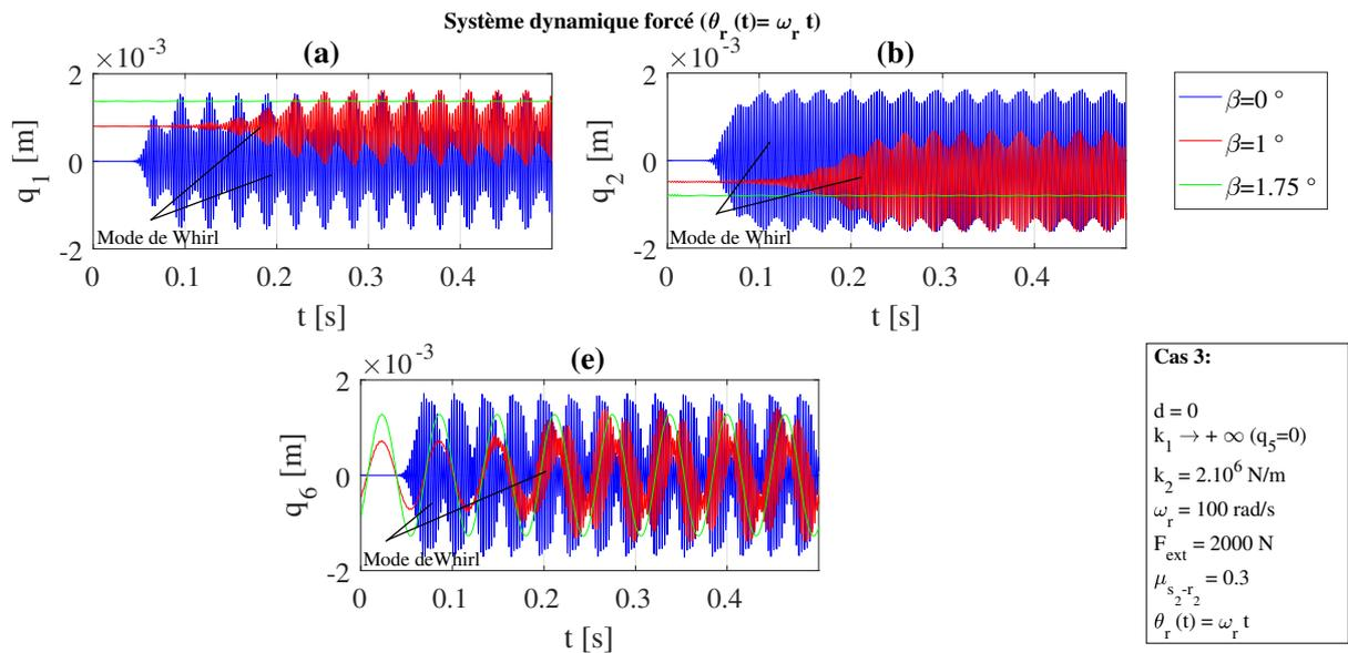
FIGURE 4 – Évolution temporelle de l'état dynamique du système  $X$  pour le **cas 3** ( $k_1 \rightarrow +\infty$ ,  $k_2 \rightarrow +\infty$ ,  $\omega_r = 100$  rad/s,  $F_{ext} = 2000$ N), un entraxe  $d_1 = 0$ , 3 valeurs d'angle  $\beta$  ( $\beta = 0, 1$  et  $1.75^\circ$ ) et avec rotation du disque rotor ( $\theta_r(t) = \omega_r t$ ). (a) Coordonnée généralisée  $q_1(t)$ . (b) Coordonnée généralisée  $q_2(t)$ . (c) Coordonnée généralisée  $q_6(t)$ .
