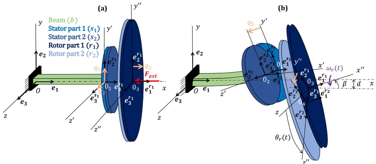
FIGURE 1 – Description du modèle phénoménologique. (a) Différentes pièces du modèle. (b) Mouvement du système en présence des jeux  $j_1$  et  $j_2$ , de l'angle d'inclinaison  $\beta$  et de l'entraxe  $d_1$ .
