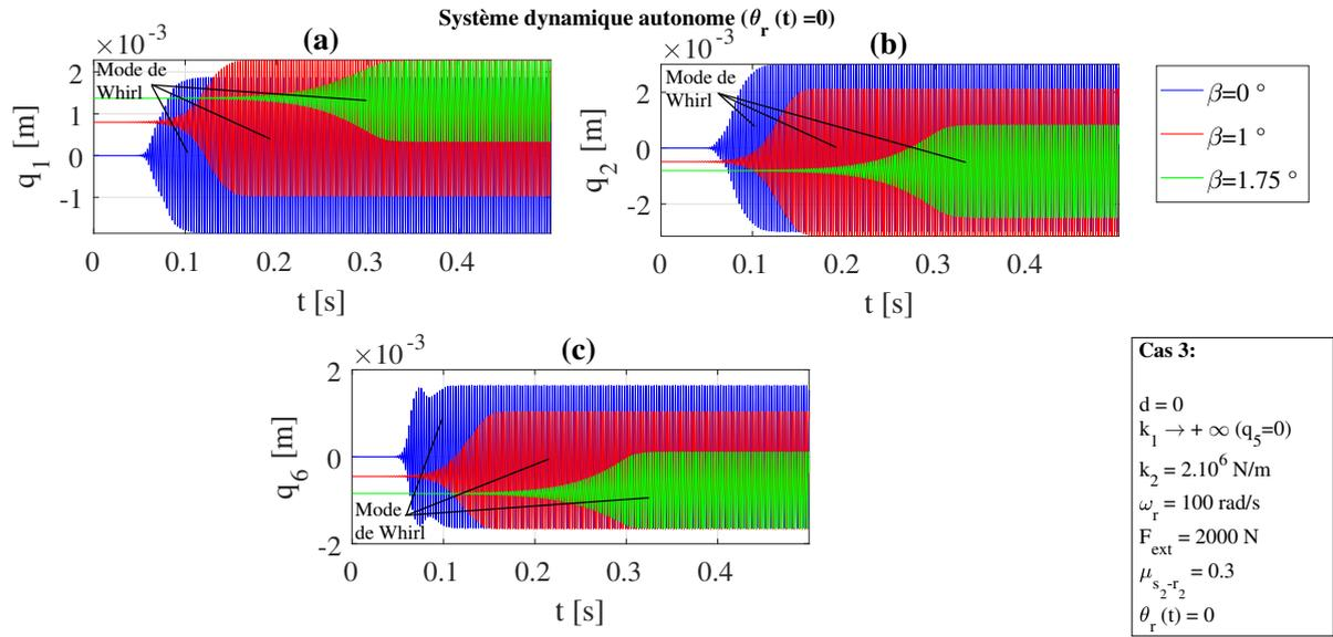
FIGURE 3 – Évolution temporelle de l'état dynamique du système  $X$  pour le **cas 3** ( $k_1 \rightarrow +\infty$ ,  $k_2 \rightarrow +\infty$ ,  $\omega_r = 100$  rad/s,  $F_{ext} = 2000$ N), un entraxe  $d_1 = 0$  et 3 valeurs d'angle  $\beta$  ( $\beta = 0, 1$  et  $1.75^\circ$ ) et avec rotation du disque rotor ( $\theta_r(t) = 0 \forall t \in \mathbb{T}$ ). (a) Coordonnée généralisée  $q_1(t)$ . (b) Coordonnée généralisée  $q_2(t)$ . (c) Coordonnée généralisée  $q_6(t)$ .
