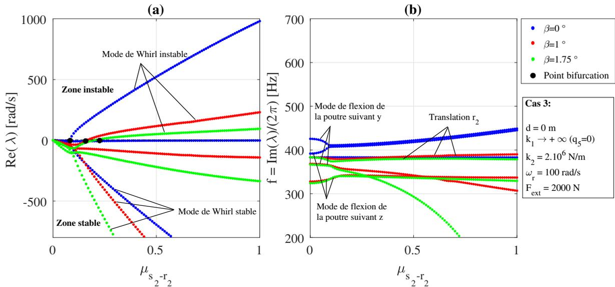
FIGURE 2 – Évolution des valeurs propres  $\lambda$  par rapport au coefficient de frottement  $\mu_{s_2-r_2}$  pour le **cas 3** ( $k_1 \rightarrow +\infty$ ,  $k_2 \rightarrow +\infty$ ,  $\omega_r = 100$  rad/s,  $F_{ext} = 2000$ N), un entraxe  $d_1 = 0$  et 3 valeurs d'angle  $\beta$  ( $\beta = 0, 1$  et  $1.75$  °). (a) Partie réelle des valeurs propres  $Re(\lambda)$ . (b) Fréquences propres  $f = \frac{Im(\lambda)}{2\pi}$ .
