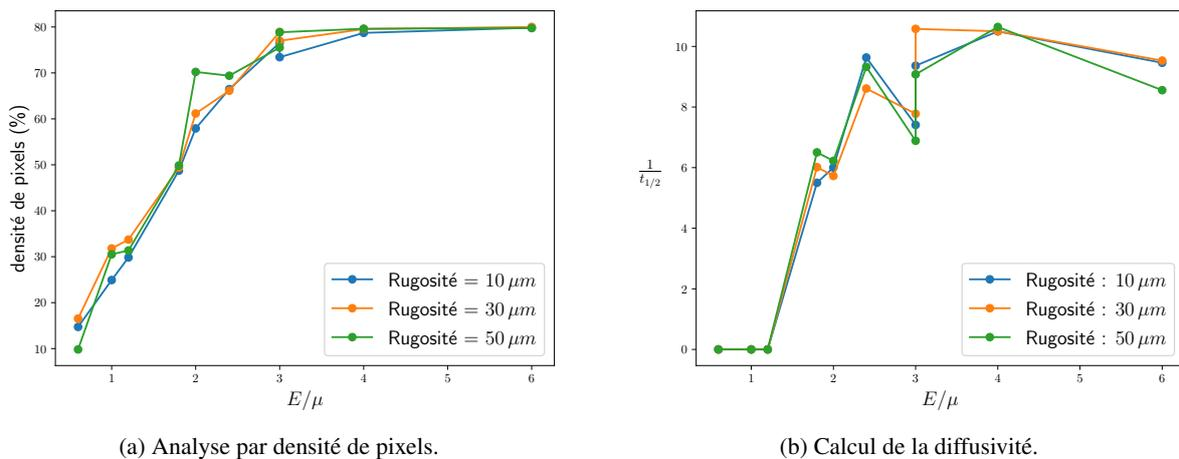
FIGURE 7 – Effet de la rugosité.
