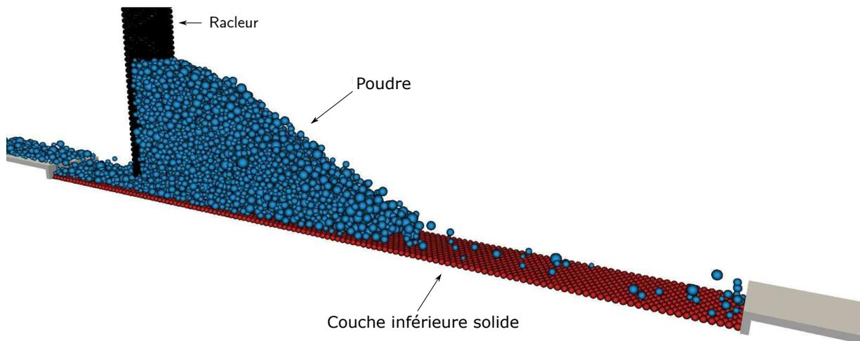
FIGURE 1 – Simulation 3D de l'étalement de poudre.
