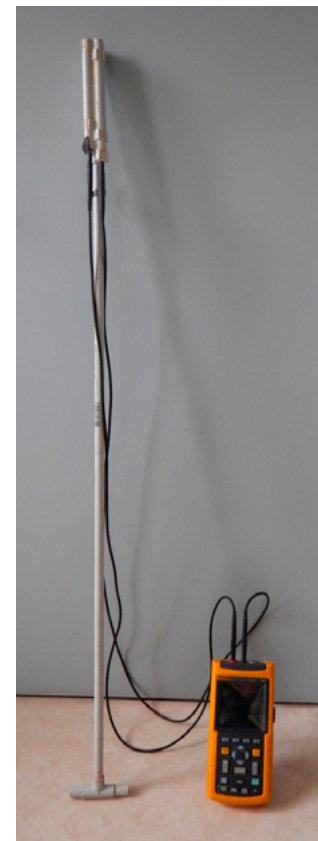
Figure 8. Sonde Penny reliée à un oscilloscope portable.
