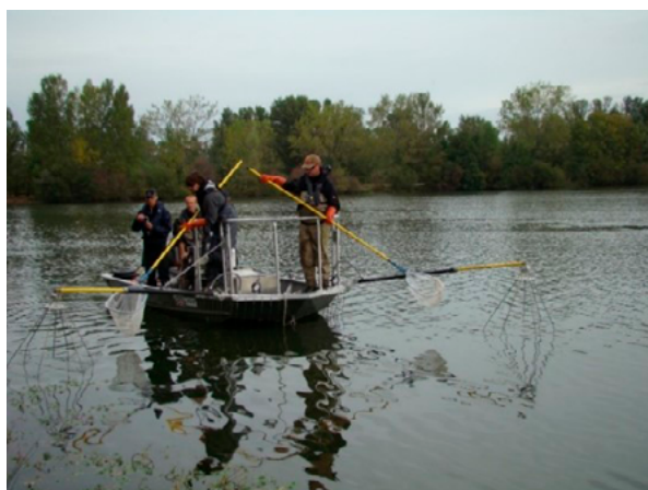
Figure 62 : Boom-boat avec deux anodes suspendues à l'avant du bateau.
