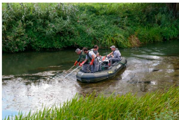
Figure 61. Pêche à l'électricité en bateau. L'engin de pêche est embarqué sur le bateau.
