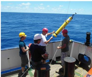
Figure 1 : déploiement d'un Mermaid dans l'océan Indien
