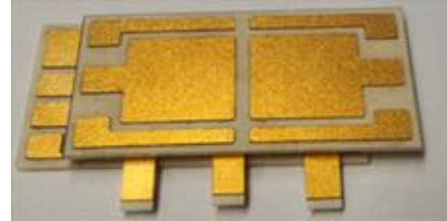
Deux démonstrateurs de module onduleur triphasé vertical double face (thèse Maxime Barrière)
