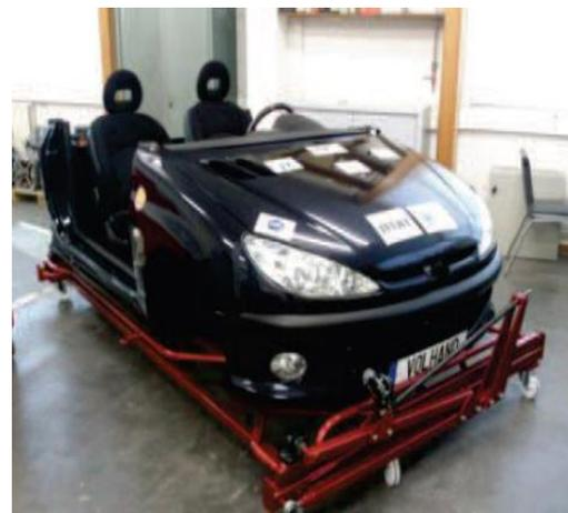
Figure 23 Maquette automobile pour analyser le geste de tourner le volant . Source : Mémoire de thèse de Jessica Schiro, 2013, p. 79, <https://www.theses.fr/171568540>
