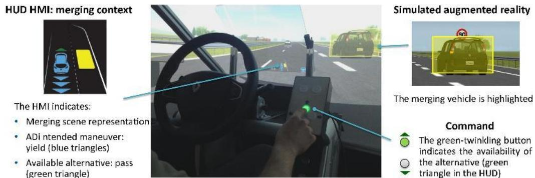
Figure 37 Etude de la réalité augmentée sur le pare-brise à affichage tête haute du simulateur de conduite de la plateforme Dr SiHMI (IRT SystemX). Source : Guo et al. (2019). <https://doi.org/10.1016/j.trf.2017.04.006>
