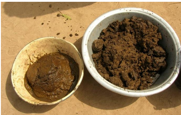
La bouse de vache est utilisée pour les enduits (Tiébélé, Région Centre-Sud) – © CRAterre
