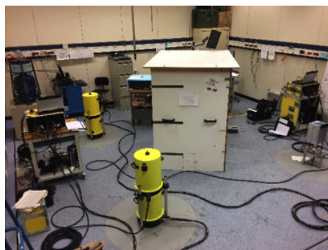
Intercomparaison de gravimètres absolus sur le site LNE de Trappes (au centre : gravimètre absolu à atomes froids CAG).
