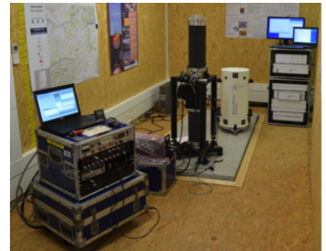
Gravimètre absolu FG5 et gravimètre absolu à atomes froids (AQG) lors d'une campagne d'intercomparaison à l'Observatoire H+ du Larzac.
