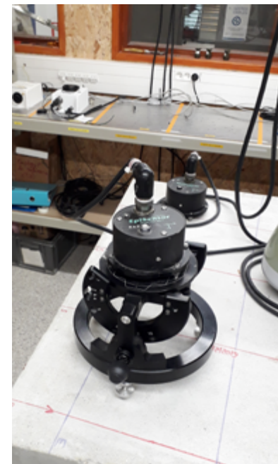
3 – Bascule - Test des capteurs accélérométriques à Grenoble - Crédits : Corallie Aubert
