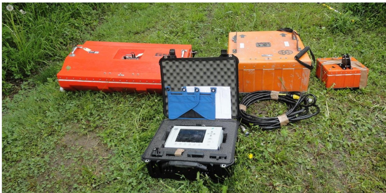
Figure 8 : Le SIR-3000 au premier plan, et de gauche à droite les antennes de 100, 200 et 400 Mhz
