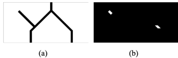
Figure 6. Masques. (a) métallisation. (b) dopage.
